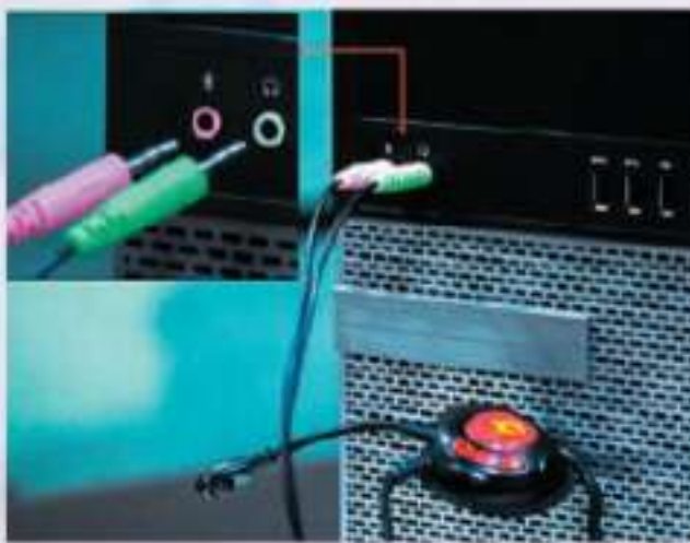
شكل (٤-١-١): توصيل سماعة الرأس بالحاسب
