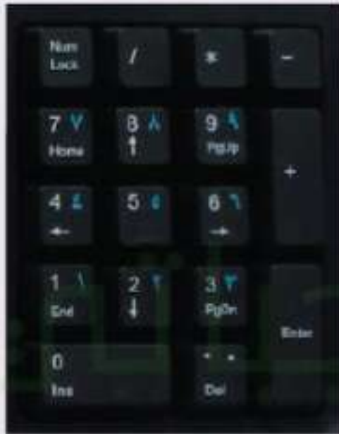
شكل (٤-١٥): لوحة المفاتيح الرقمية
