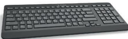
**لوحة المفاتيح (Keyboard)** هي إحدى أهم أجهزة الإدخال للحاسِب، حيث يمكن للمستخدم من خلالها إدخال النصوص وإعطاء الأوامر للحاسِب.
