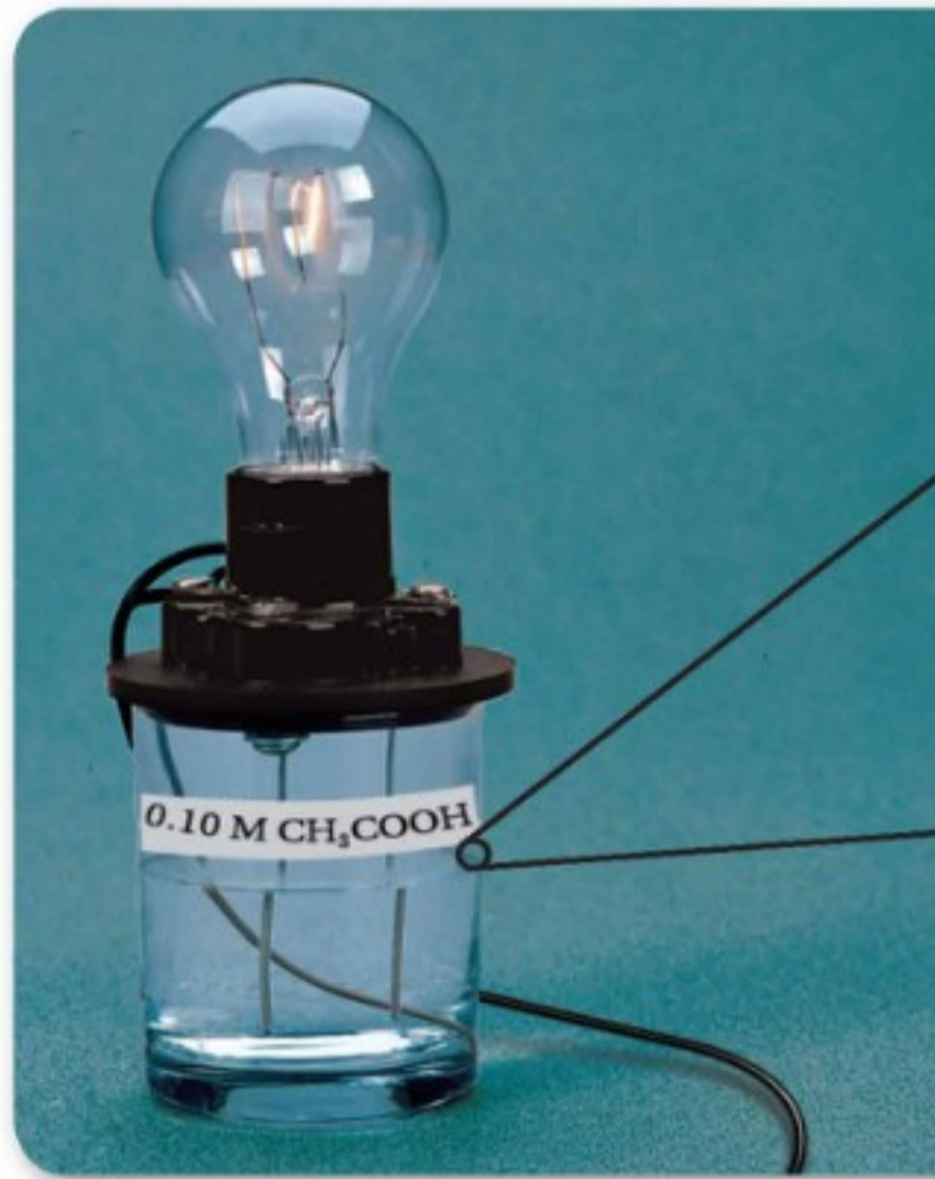
الشكل 3-12 عند وضع الأقطاب في محلول حمض الإيثانويك بتركيز 0.10 M يكون الضوء خافتًا. قارن هذه الصورة بالشكل 5-11. فسر الفرق بين شدتي إضاءة المصباحين بحسب تركيز الأيونات في المحلول.
