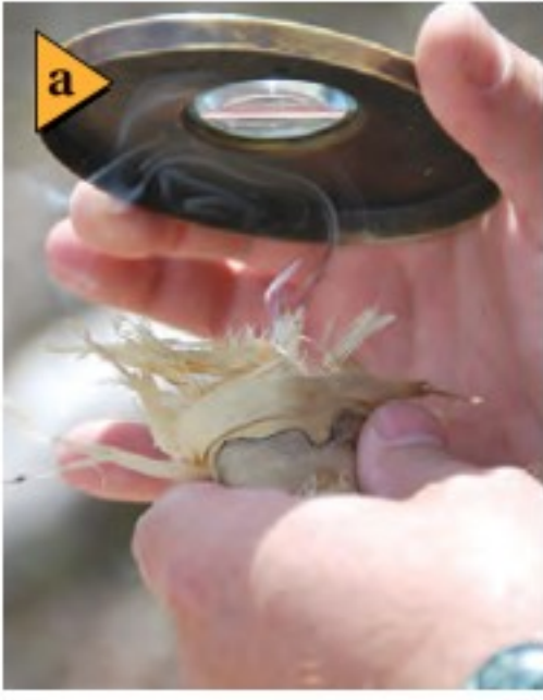
الشكل 10-3 يمكن استخدام عدسة مجمعة لحرق ورقة (a). يتجمع الضوء الداخل بصورة موازية للمحور الرئيسي عند بؤرة العدسة، ولذا تتركز الطاقة الشمسية (b).
