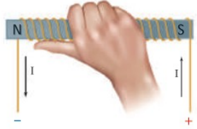
الشكل 1-12 تستخدم القاعدة الثانية لليد اليمنى في تحديد قطبية المغناطيس الكهربائي.
