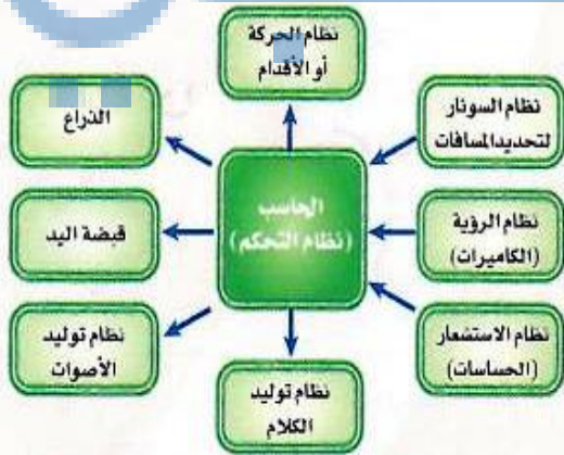
شكل (٩-٤): النظم الفرعية التي يتكون منها الروبوت
