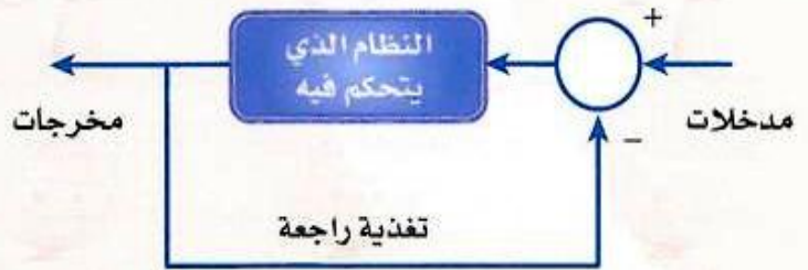
شكل (٨-٤): المكونات الرئيسية في نظام التحكم ذي الدائرة المغلقة
