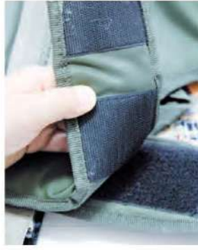
تستعمل ألياف النايلون في صناعة أشرطة التثبيت.
