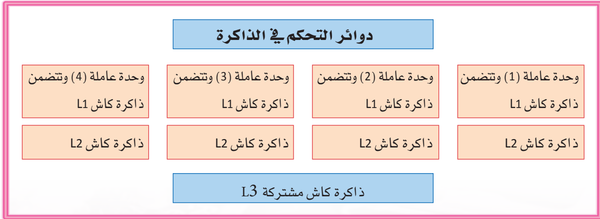
شكل (5-6): نموذج مبسط للبنية الداخلية لمعالج متعدد الوحدات (Multi-Core)
