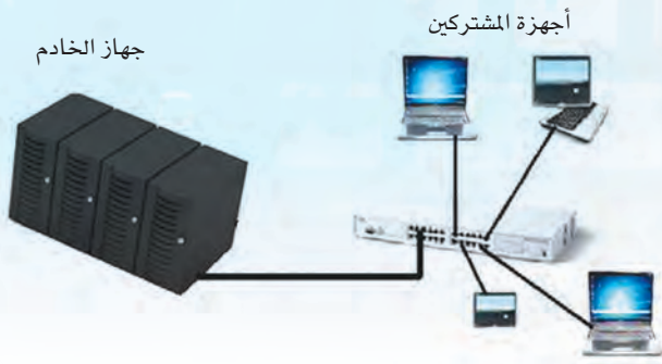
شكل (١-١) شبكة الخادم والعميل (Client & Server)
