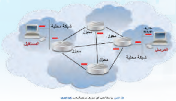
شكل (1-11) نقل وتبادل المطروف بين المحولات باستخدام مداوات (TCP/IP)
