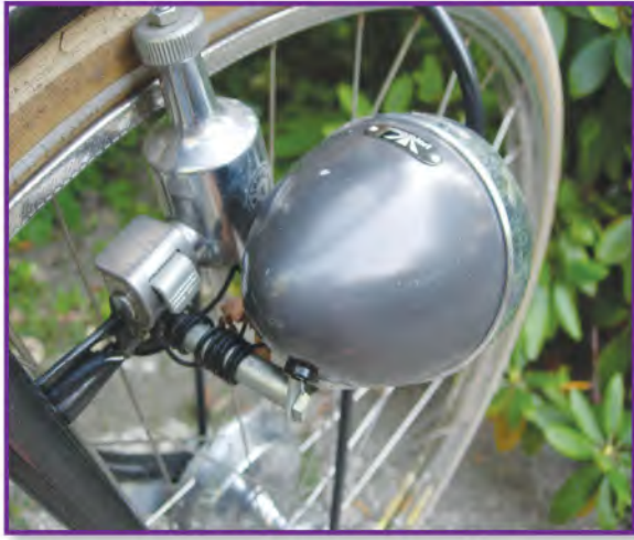
يتصل المولد الكهربائي بعجلة الدراجة
