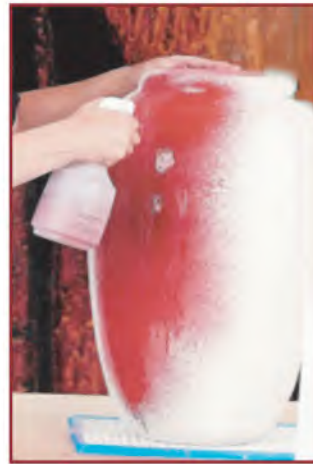
الشكل (٣١) : استخدام البخاخة في تطبيق البطانات.
