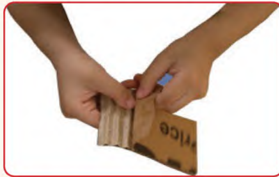
شكل (٥٩): طريقة فك طبقة من الكرتون.
