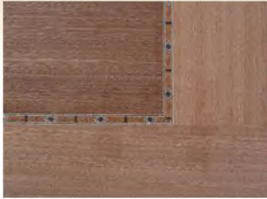
الشكل (١٥٩): تستخدم القشرة لتغطية الأسطح الخشبية على مساحات كبيرة .
