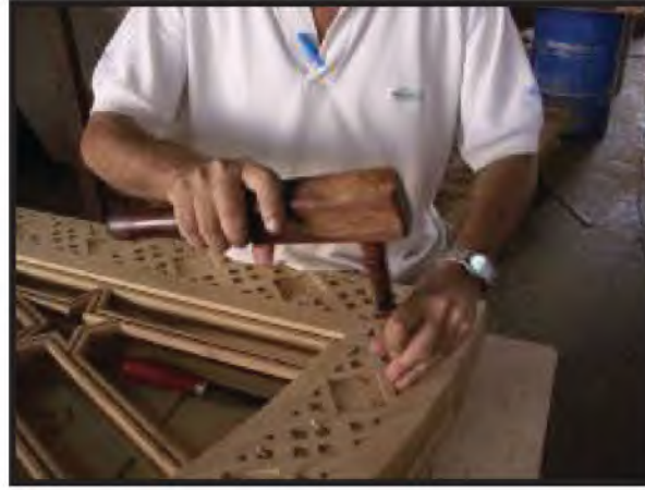
(١) : استخدام المدق الخشبي ، وهي الأداة الصحيحة .
