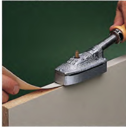
الشكل (١٦٠): وتستخدم أيضاً لتغطية مساحات صغيرة كحواف الأخشاب . وبتنوع أنواع الأخشاب وألوانها، تتنوع قشرة الخشب . لذا فإنها مناسبة جداً لتزيين الأبواب، والصناديق الخشبية، والطاولات . هذا بالإضافة إلى إمكانية عمل لوحات فنية باستخدامها .
