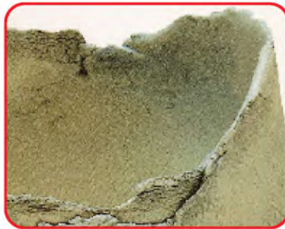
شكل (١٠٦): يوضح نتائج أخطاء التجفيف ( تشقق ).
