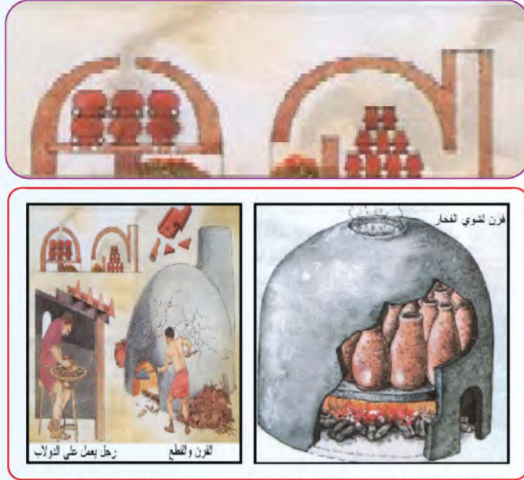
شكل (١١٥ ج) الطريقة البدائية الثالثة توضح شكل الفرن وطريقة رص الأعمال ومكان تغذية النار.
