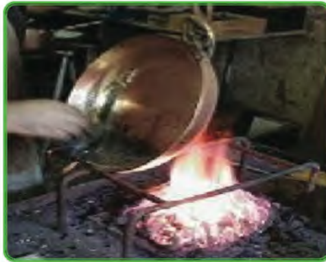
الشكل (٦٧): التخمير «تسخين المعدن لإكسابه اللدونة».
